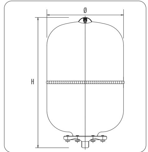
Réservoir multifonction à vessie remplaçable pour systèmes d'eau sanitaire.
